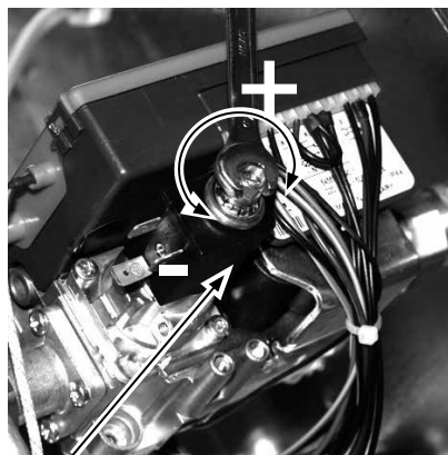
Před nastavením výkonu sejměte šedou krytku regulačního stavěcího šroubu
